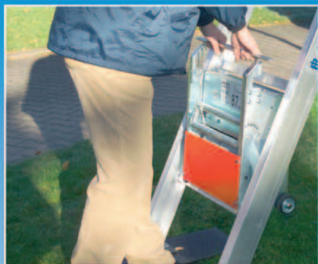
Fixer le boîtier moteur en face avant.
